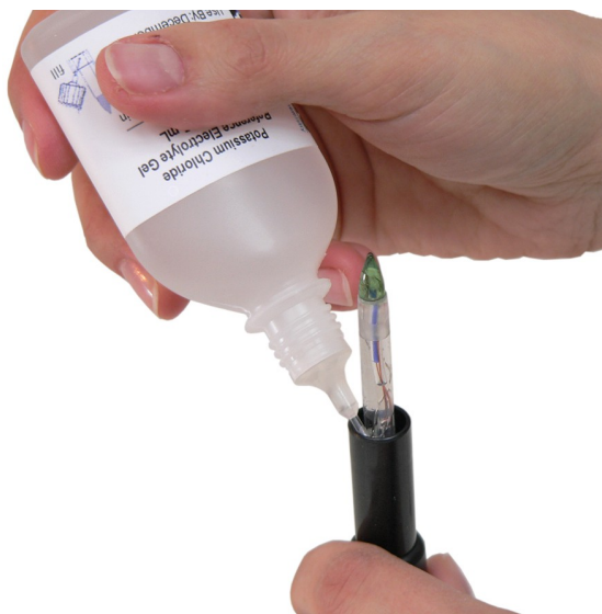
Uzupełnianie elektrolitu żelowego w kołnierzu elektrody
