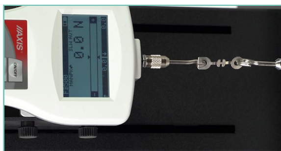
Pomiar siły zrywającej detalu
