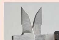
Powierzchnie pomiarowe z węgla spiekanego
