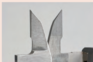
Powierzchnie pomiarowe szczęk z węgla spiekanego
