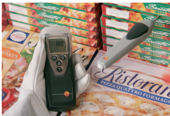
Kontrola przychodzących towarów, bez kłopotliwych kabli dzięki sondzie radiowej
