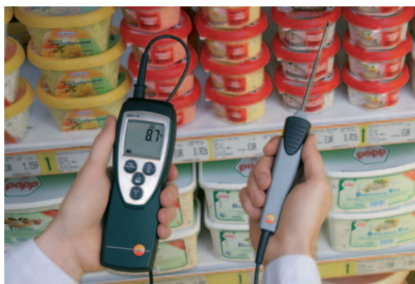
Pomiar temperatury w ladzie chłodniczej
