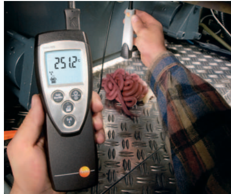
Pomiar temperatury w materiałach półstałych za pomocą super szybkiej sondy penetracyjnej, idealnej do tworzyw sztucznych, artykułów spożywczych itp.
