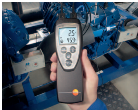
Jednoczesny pomiar przegrzania i niedostatecznego chłodzenia w systemach chłodniczych za pomocą testo 922
