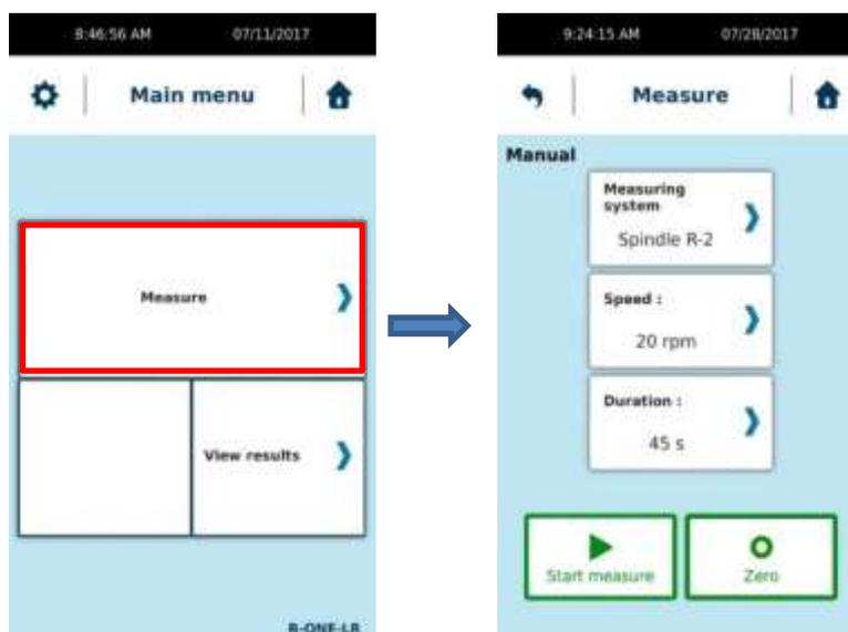
Manual Mode enables to choose your measurement parameters like «Measuring System », « Speed or shear rate» then « Time of measurement ».
